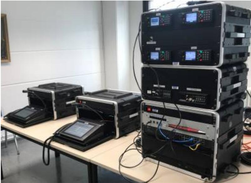
Gesamtbild eines betriebsbereiten Kommunikationsknotens mit Geräterack und zwei abgesetzten Bedienstellen
