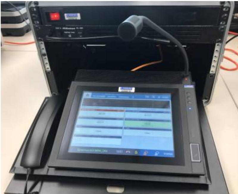
abgesetztes Bediengerät als PC mit Touch-Oberfläche
